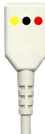
Abb. 39 Farbkodierte Anschlüsse an der Verteilerweiche des EKG-Patientenkabels
