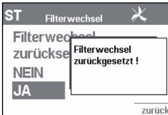
5. Wenn Sie **Ja** mit dem Drehknopf ausgewählt und bestätigt haben, erscheint für ca. 3 Sekunden die Meldung **Filterwechsel zurückgesetzt!**
