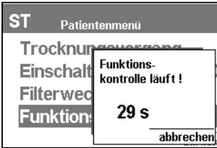
Es öffnet sich das Meldefenster **Funktionskontrolle läuft!**. Die Restdauer der Funktionskontrolle wird angezeigt.
