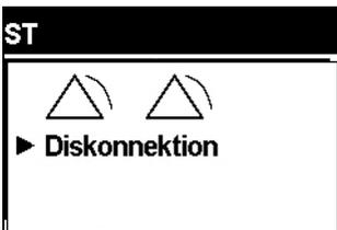
Wird durch einen Fehler ein Alarm ausgelöst (hier: Diskonnektionsalarm), drücken Sie die Alarmquittierungstaste
