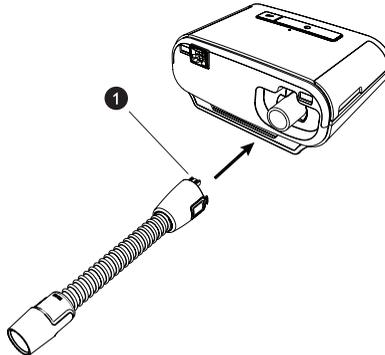
2. Drücken Sie den Schlauch über den Luftauslass-Anschluss, bis die Laschen an der Schlauchseite mit einem Klick in die Schlitzlöcher an den Seiten des Auslass-Anschlusses einrasten.
