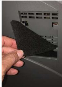
Reinigen Sie beide Filter durch absaugen, ausklopfen oder auswaschen.
