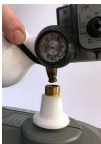
Der Anschluss rastet ein, indem der Verriegelungsring nach oben schnappt
