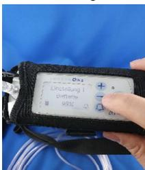
Mit den (- oder +)Tasten stellen Sie die Flussrate (Flow) ein (Stufe 1 bis 3)
