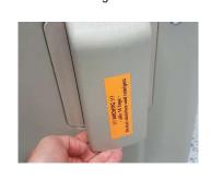
Filter trocken einsetzen
