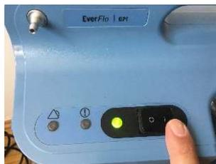
Die grüne LED zeigt an, dass das Gerät richtig funktioniert
